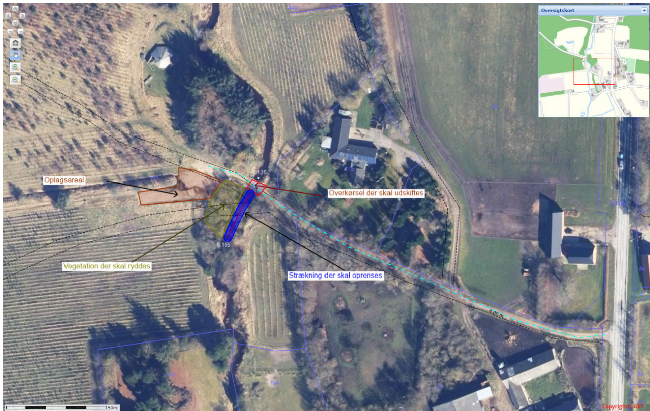
Figur 3.5.1 Restaureringstiltag for strækning st. 5.125 – 5.210 m. Der udskiftes overkørsel (rød firkant), oprenses bund (blåt areal) samt udlægges skjulesten (blåt areal). Derudover ryddes der vegetation (grønt areal). Turkis stiplede linje angiver kørselsvej.
